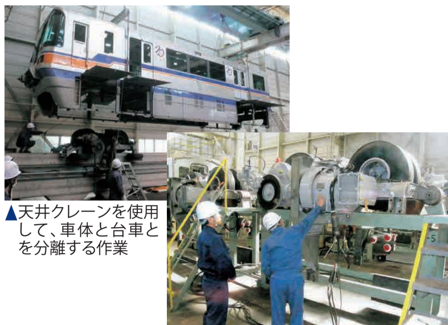
▲台車単体での分解検査
