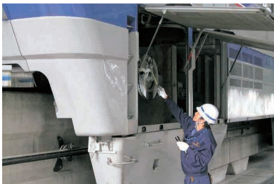
▲床下の点検ハッチを開いて、目視と打音による台車の検査
