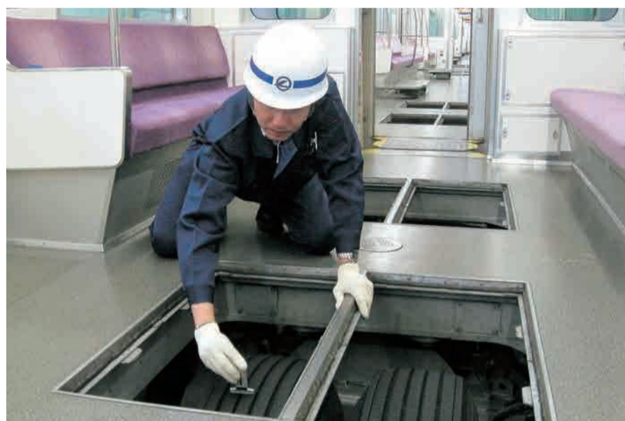
▲タイヤ摩耗量の測定
