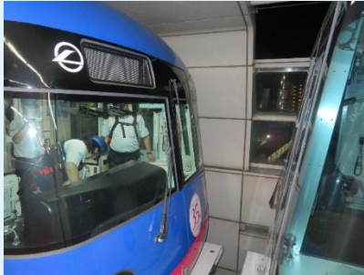
異常時における併結運転訓練
