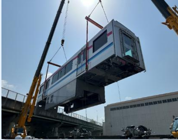
新型車両の搬入状況
